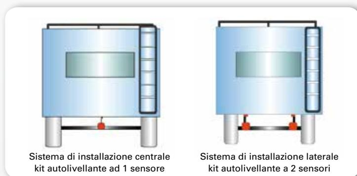
Si tratta di un insieme di sensori di livellamento che, unitamente all'impianto elettrico, al compressore e ad altri componenti secondari, consente di autolivellare il veicolo durante la marcia. Questo kit può essere installato su tutti i sistemi di sospensione pneumatica aggiuntiva anche post-vendita. È possibile ordinare il sistema di autolivellamento pneumatico oppure elettrico come si evince dalla tabella sottostante.
