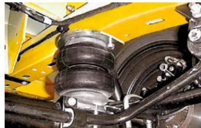
È un sistema testato dal TÜV, idoneo per veicoli dotati di ABS, furgonati e a telaio: è costituito da 2 soffietti a doppia balza che consentono di aumentare il peso di carico totale del veicolo da 35 a 40 q.li. Ideale per evitare rollii, sbandamenti e ottimale per migliorare la tenuta di strada. È dotato di compressore e manometro.
