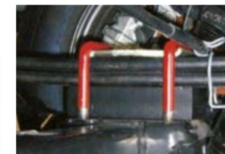
Il sollevamento di un veicolo viene limitato dall'altezza dell'ammortizzatore. L'impiego di più kit di spessori e un ulteriore sollevamento della parte posteriore sullo stesso veicolo con sospensioni ad aria sono possibili solo entro determinati limiti. Per la combinazione di più sistemi (spessore+sospensione) è opportuno chiedere prima al centro Goldschmitt.
