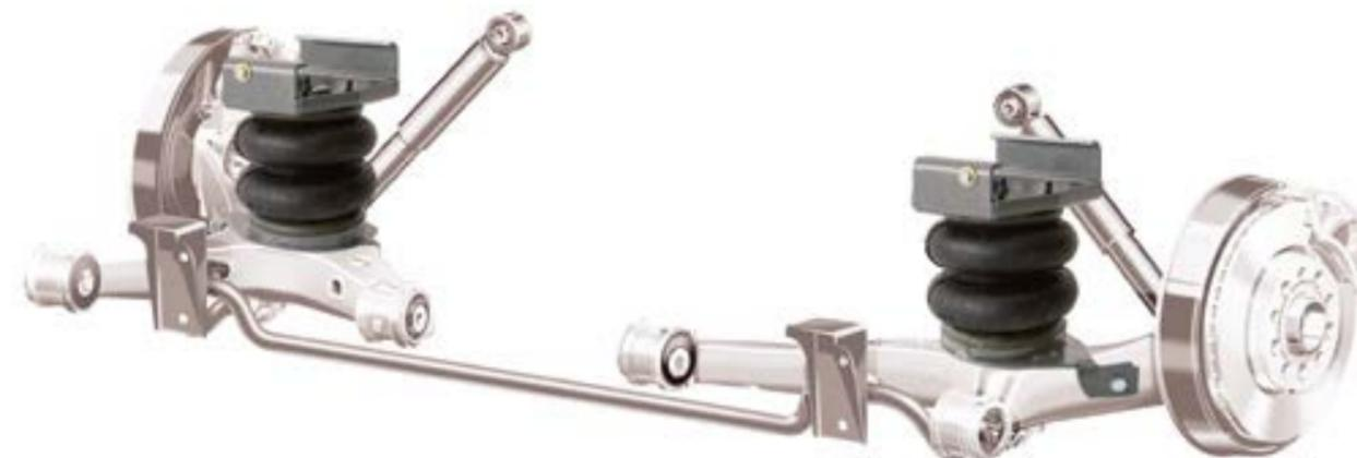
Grazie al sistema è possibile gestire assale anteriore o posteriore singolarmente oppure l'intero veicolo attraverso 2 o 4 soffietti indipendenti. A seconda delle condizioni di carico, la pressione dei soffietti viene aumentata o ridotta per mezzo dell'unità di controllo ADC che viene azionato automaticamente all'accensione del veicolo.
