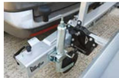
Un ruotino o un perno rotante permette l'apertura della struttura stessa, **SENZA DOVER TOGLIERE LE MOTO O LE BICI**, e di conseguenza delle porte posteriori del veicolo
